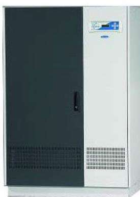
Esispower ATLAS Serisi trafoolu kesintisiz güç Kaynağında çitayı yükselterek 300kVA ürünü piyasaya sundu. PWM (Darbe Genişlik Modülasyonu) ve IGBT teknolojileri ile üretilmiş, mikroişlemci kontrollü, tam sinüs çıkışlı, ONLINE, istendiğinde paralel bağlanabilen Kesintisiz Güç Kaynakları Serisidir.
